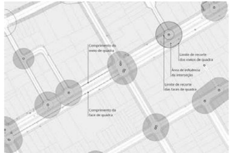
Figura 3 - Definição da área de influência da interseção e os pontos centrais dos cruzamentos correspondentes, a partir dos quais o raio calculado é traçado.
