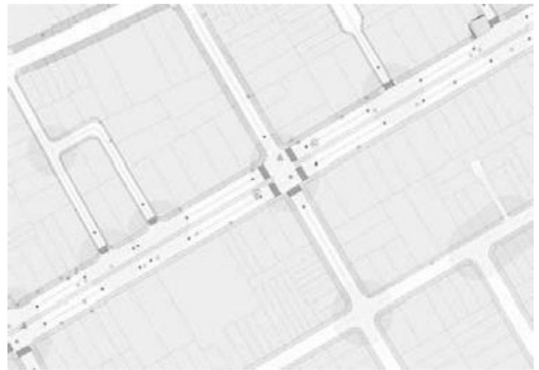
Figura 5 - Exemplo de um trecho da base de travessias levantadas ao longo dos 430 km de vias principais. Os pontos de interseção entre o eixo do leito e a área de influência da interseção representam a quantidade de aproximações que potencialmente seriam contempladas por travessias.
