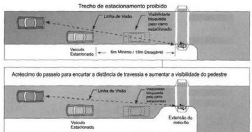
Figura 25 – Distância recomendada entre a travessia de pedestres e o estacionamento. FONTE: DNIT -Publicação IPR - 740 MANUAL DE PROJETO GEOMÉTRICO DE TRAVESSIAS URBANAS
